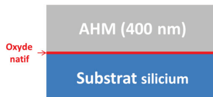
Figure II-3 : Empilement des échantillons avant les étapes de photolithographie et de gravure.
