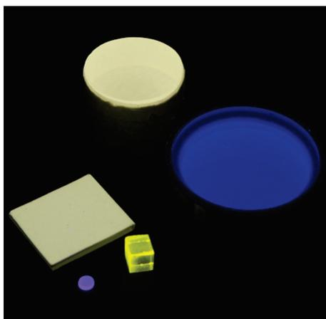
**Fig. 1.1** – Exemples de scintillateurs sous excitation UV. En blanc/jaune des cristaux de CsI : Tl émettant un très large spectre dans le visible. En bleu, à droite, un cristal de CsI : Na avec un maximum d'émission à 420nm. Le cristal de  $Gd_3Al_2Ga_3O_{12}$  :  $Ce^{3+}$  émet principalement dans le jaune grâce à son dopage. En bas, une céramique de  $BaAl_4O_7$  :  $Eu^{2+}$  présente une émission bleue centrée à 450 nm.
