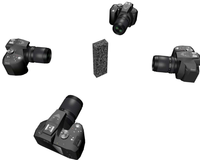
FIGURE 2.32 : Illustration schématique du montage de stéréo-vision avec un objet (parallélépipédique) composé de plusieurs surfaces au centre entouré par 4 appareils photographiques. Cet exemple élémentaire sera utilisé dans la partie 2.4 pour illustrer la méthode proposée
