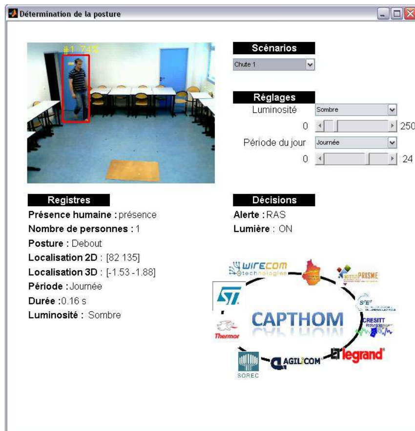
FIG. 3.39 – Déclenchement du dispositif d'éclairage en fin de journée.
