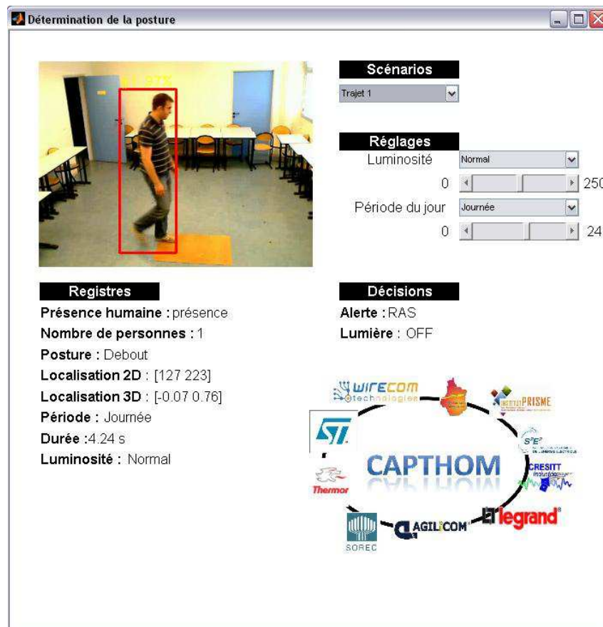
FIG. 3.38 – Non déclenchement du dispositif d'éclairage de la pièce.
