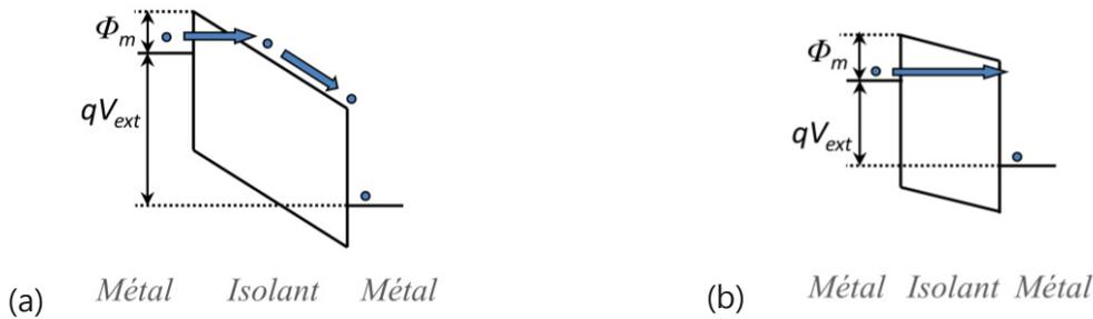
**Figure 1.29 : Schéma du diagramme de bande d'une structure Métal/Isolant/Métal lors de l'effet tunnel, (a) dans le cas Fowler Nordheim, (b) dans le cas de l'effet tunnel direct [115].**
