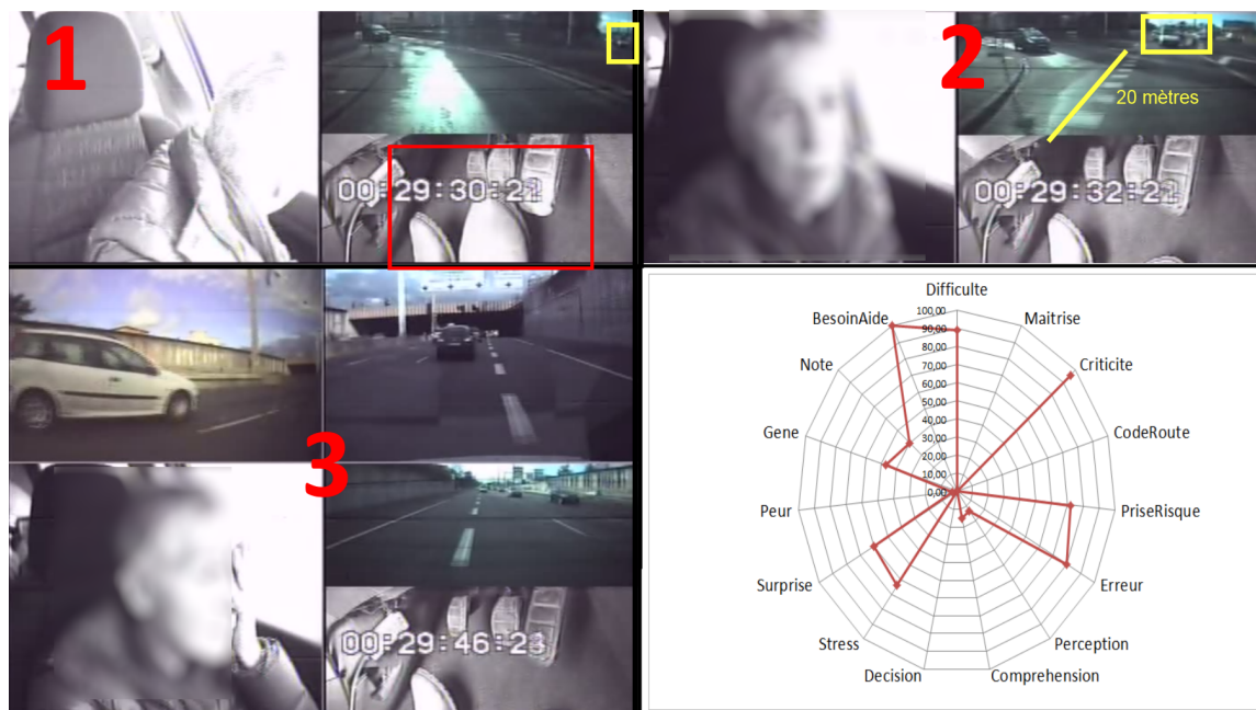
FIGURE 56 – Cas d'espace d'insertion trop court, en cédez-le-passage
