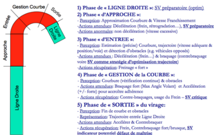
FIGURE 159 – Modélisation de l'activité de franchissement d'un virage à droite, au niveau tactique
