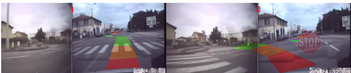
FIGURE 146 – Illustration d'un principe de réalité augmentée pour l'aide à la sélection d'un créneau d'insertion
