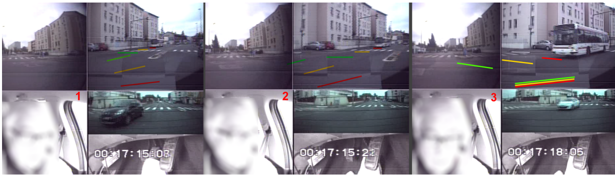
FIGURE 145 – Évolution dynamique des conflits de zones enveloppes au cours de la manœuvre
