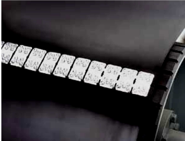
Figure A.41. Système rigide à rivets.
