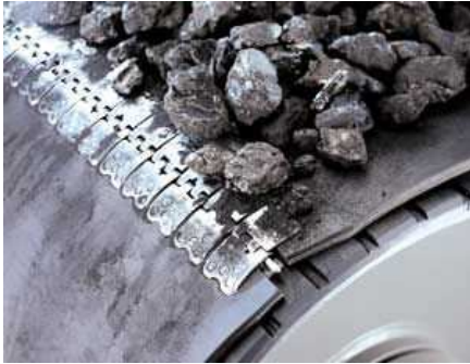
Figure A.33. Charnière plate avec rivets.
