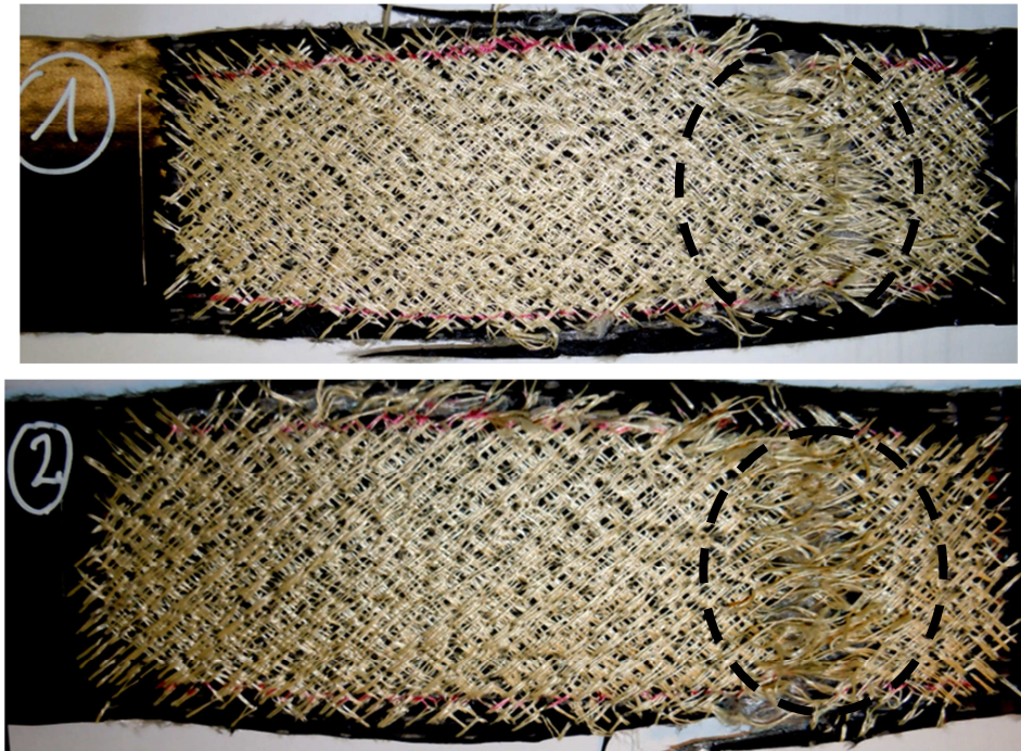
Figure 4.62. Jonctions cousues rompues.
