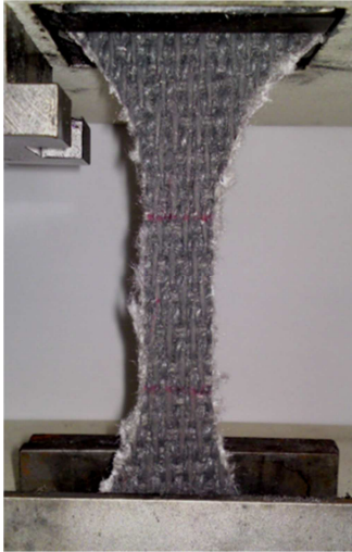
Figure 4.39. Haltère de carcasse en test.
