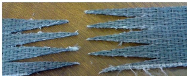
Figure 4.35. Carcasse découpée avec des dents.
