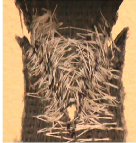
Figure 4.29. Résultat de l'assemblage avec une dent.
