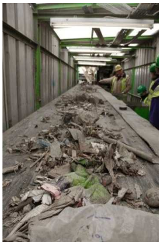
Figure A.4. Exemples de bandes plates : tri de déchets et convoyage de marchandise.
