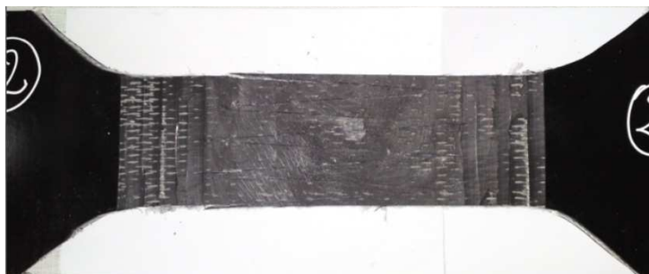
Figure 4.65. Échantillons de bande transporteuse en haltère.
