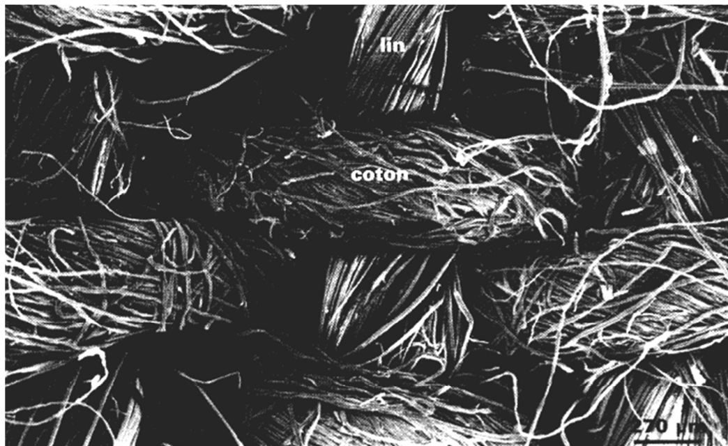
Figure A.11. Image microscopique d'un tissu toile.
