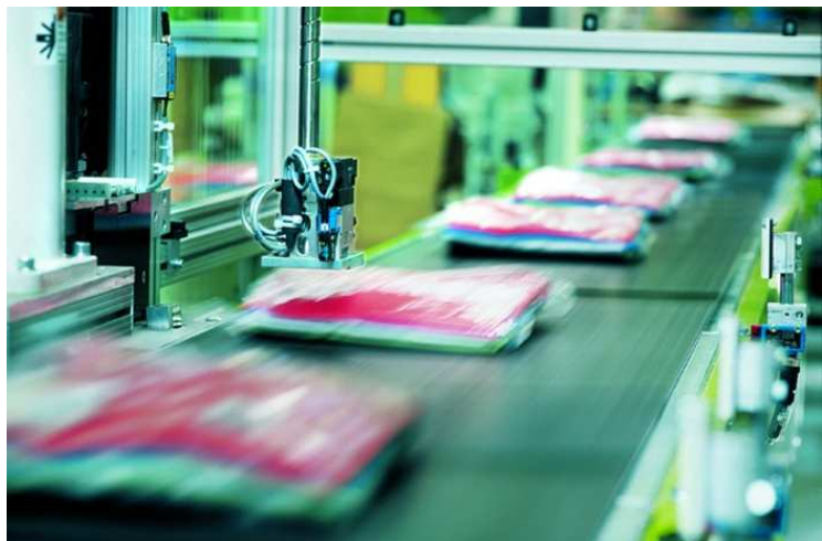
Figure A.4. Exemples de bandes plates : tri de déchets et convoyage de marchandise.
