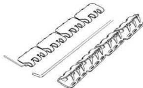
Figure A.36. Charnière plate avec crochets.
