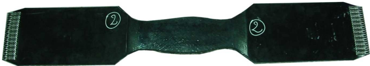
Figure 4.69. Échantillon jonctionné mécaniquement pour essai sur la banc dynamique.
