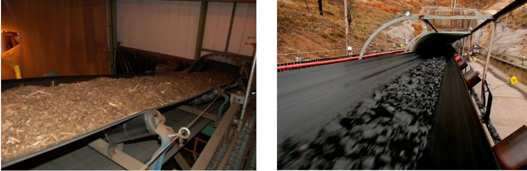
Figure A.5. Exemples de bandes en auge : convoyage de pulpe et convoyage de charbon.
