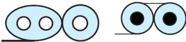
Figure A.26. Cassette de bobines enroulées avec la fin à l'extérieur.
