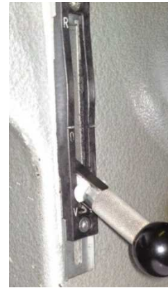
Figure 4.23. Commande manuelle de sens de couture.
