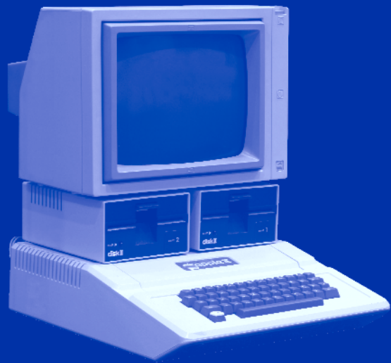
[ P. 77 ] Ordinateur Apple II avec lecteurs de disquette DISK II et moniteur d'affichage.
