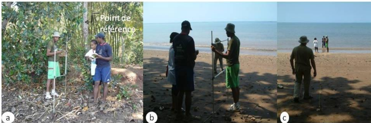
Planche photographique 4-1: Méthode de suivi du profil topographique au niveau de la plage Barakani a) début des mesures du profil sur la haute-plage b) suivis des mesures sur l'estran c) fin des mesures du profil vers l'avant-plage (cliché, G.Pennober, 2009)
