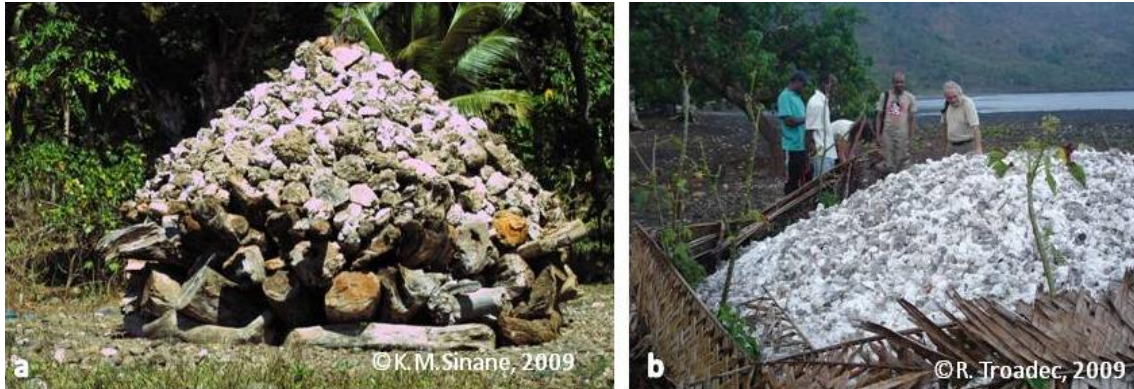
Planche photographique 6-2: Des fours à chaux à Hajoho a) préparation d'un four à chaux b) la chaux obtenue après la cuisson
