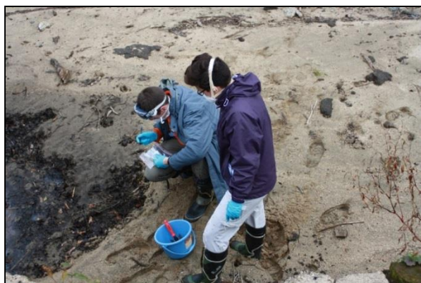
Figure II - 2-3 - Identification d'un prélèvement de laisse de crue – Source : H. Lepage
