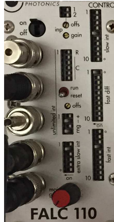
FIGURE 2.5 – Le FALC 110, on peut voir les différents filtres et leurs interrupteurs d'ajustement, ici le FALC 110 est déjà réglé pour asservir le laser sur la transition |F = 2\rangle \rightarrow |F' = 2\rangle de la raie D2 du rubidium.
