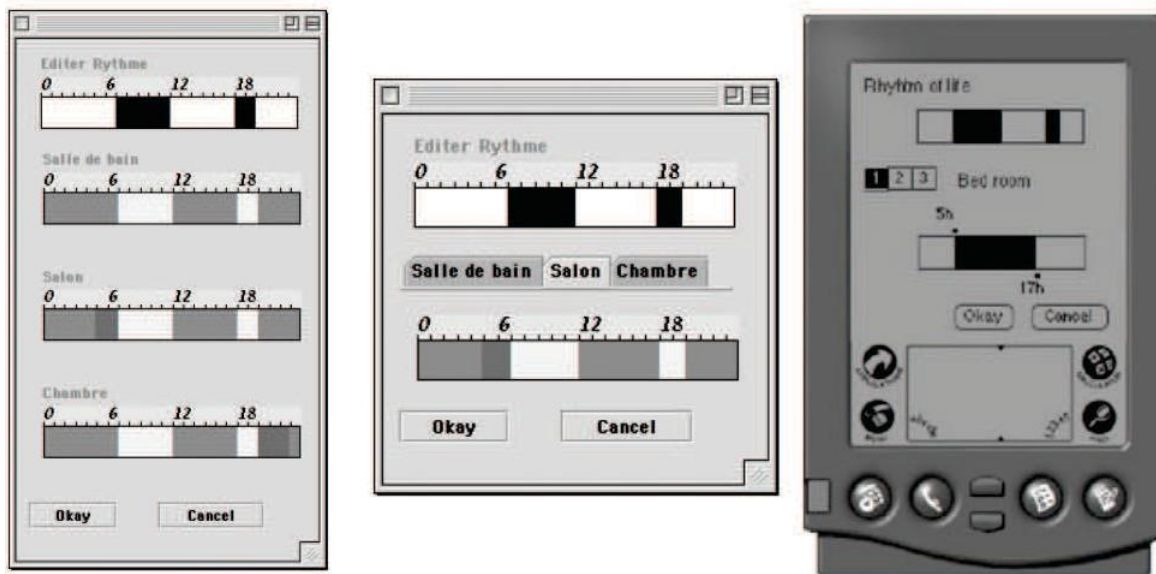
Figure 1.10 – Exemple d’une IHM plastique. Ici, un système de contrôle de chauffage adapté à trois cibles différentes, notamment impacté par les spécificités matérielles. Figure adaptée depuis [113].
