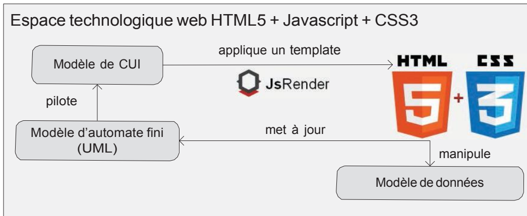
Figure 4.3 – Schéma de l'environnement d'exécution des modèles de CUI via ADAGIOS (sur base de GENIUS).
