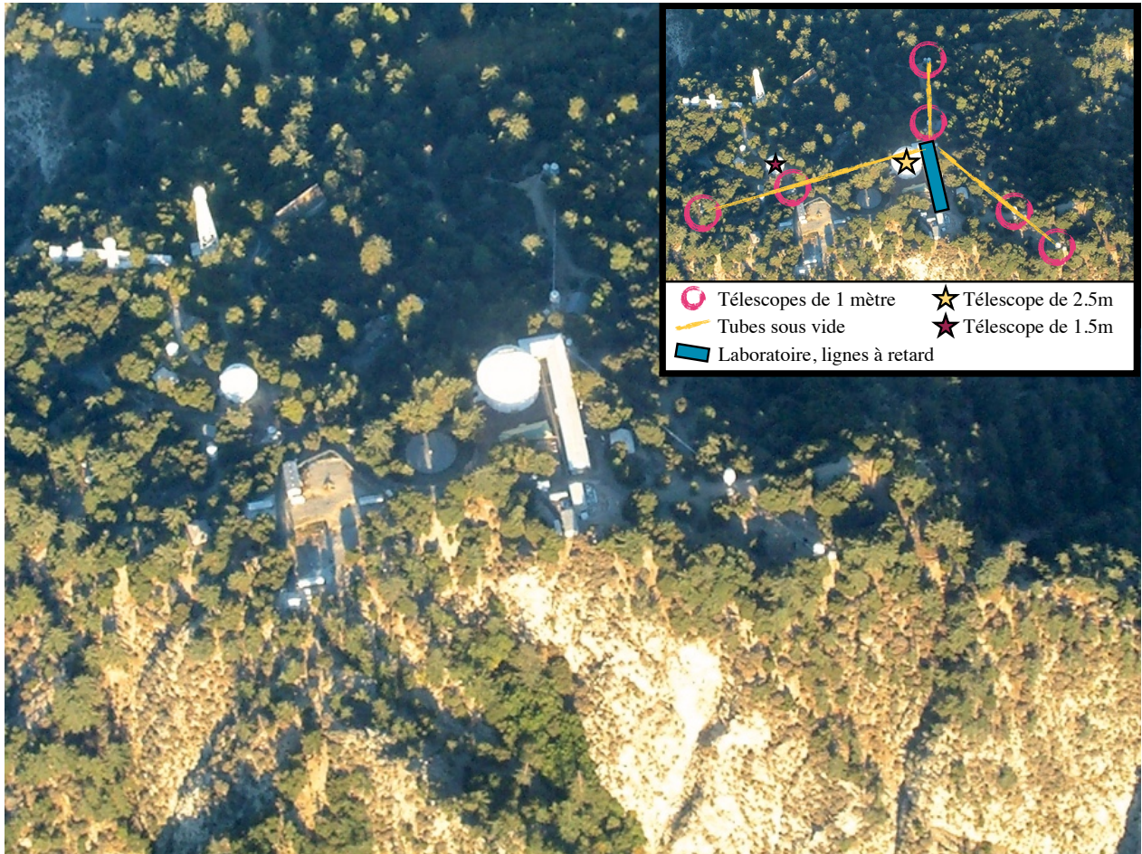
FIGURE 1.23 – Vue aérienne de l’observatoire du Mont Wilson, abritant l’interféromètre à longue base CHARA.
