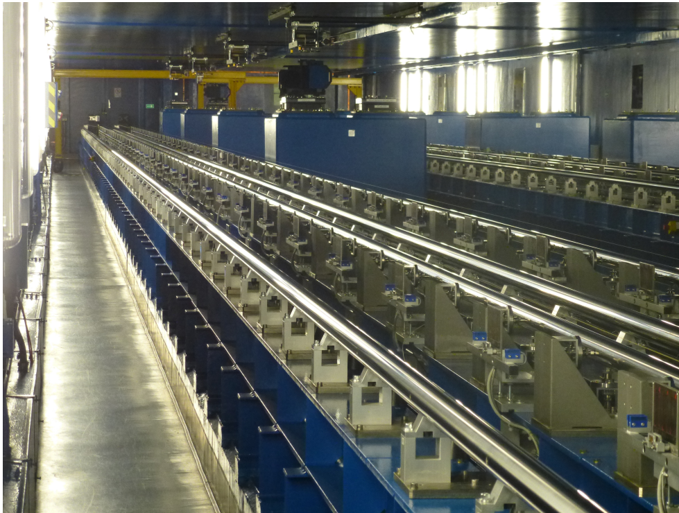
FIGURE 3.2 – Les lignes à retard du VLTI permettent d'égaliser les chemins optiques des faisceaux lumineux provenant des différents télescopes.
