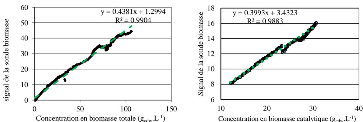
Figure 51 : Corrélation existante entre la biomasse et le signal de la sonde biomasse issues fermentation en mode fed-batch de *Rhodotorula glutinis* à partir de glucose et glycérol comme substrats a) biomasse totale en condition de croissance, b) biomasse catalytique après mise en place de la limitation azote.
