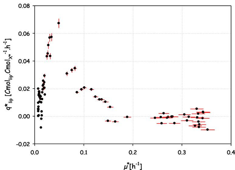
**Figure 49:** Evolution de la vitesse spécifique réelle d'accumulation de lipides en fonction du taux spécifique de croissance réel lors d'une culture de *R. glutinis* à 30°C, pH 5.5 avec le glucose comme substrat (Cescut, 2009)
