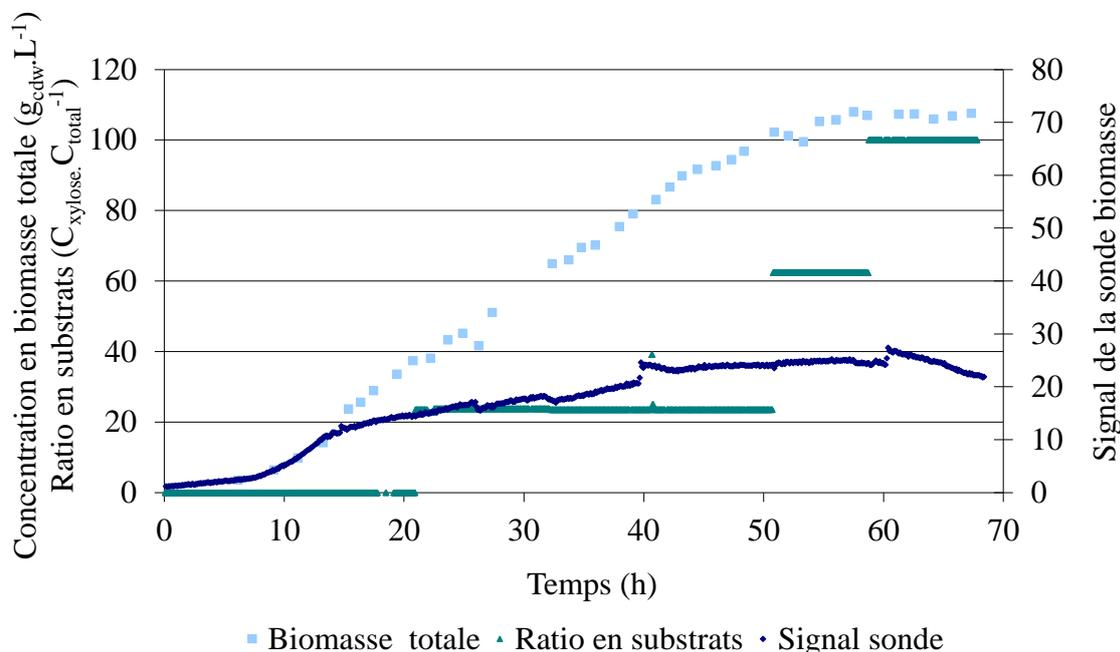
Figure 50 : Biomasse totale, signal de la sonde biomasse et ratios en substrats lors de cultures de *Rhodotorula glutinis*, mode fed-batch, 30°C, pH 5.6, milieu salin, limitation azote, substrats glucose et xylose.
