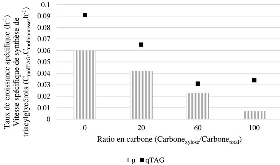
Figure 46 : Taux de croissance et vitesses spécifiques de production de TAG lors d'une culture de *Rhodotorula glutinis*, mode fed-batch,  $30^{\circ}\text{C}$ , pH 5.6, milieu salin, substrats glucose et xylose, limitation azote.
