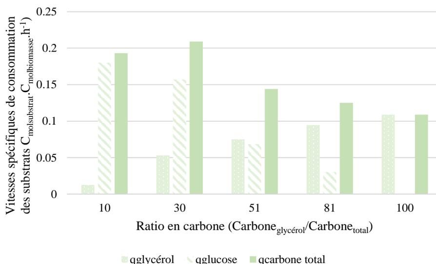
**Figure 45 : Vitesses spécifiques de consommation des substrats lors d'une culture de *Rhodotorula glutinis*, mode fed-batch, 30°C, pH 5.6, milieu salin, substrats glucose et glycérol, limitation azote.**
