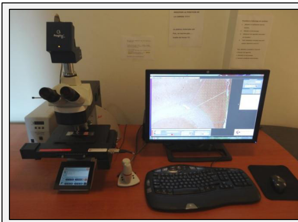
Figure 54. Station d'imagerie Explora Nova au LNCA. Un microscope optique Leica est relié à un ordinateur via une carte contrôleur pour permettre la manipulation de la platine depuis le programme Mercator (ou à l'aide du joystick à 3 axes), et une caméra numérique permet l'acquisition des images.
