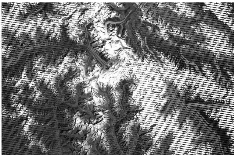
FIGURE 4.1 – Exemple d'image Landsat 7 après la panne du Scan Line Corrector en mai 2003 entraînant la présence de bandes noires sur les images
