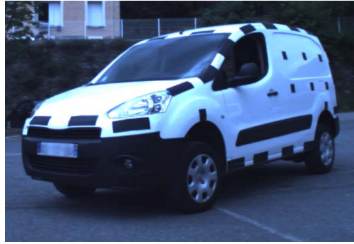
FIGURE 7.15 : Véhicule utilisé pour l'évaluation de l'incertitude des mesures.
