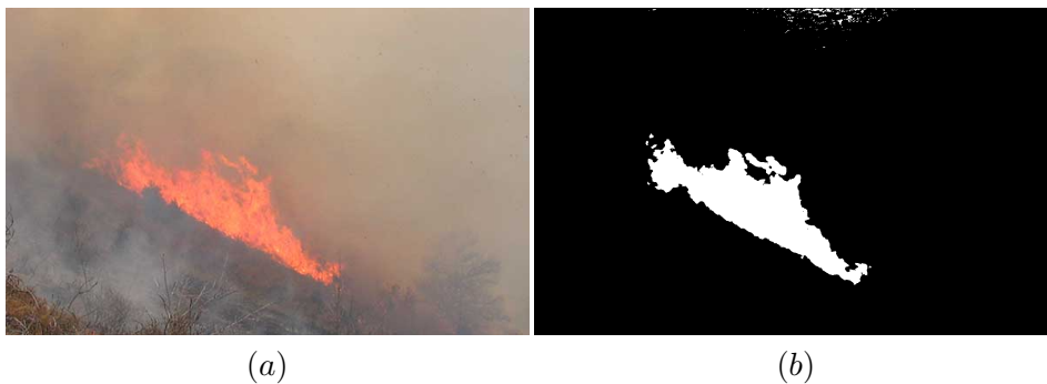
FIGURE 3.13 : Exemple de détection de la méthode SVM. (a) Image originale, (b) Pixels détectés par SVM avec élimination des régions de pixels détectées dont la taille est inférieure à 10 % de la taille de la plus grande région.
