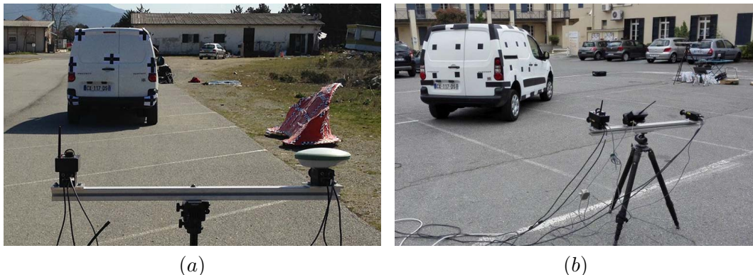
FIGURE 7.16 : Configuration de prise d'images. (a) un seul système de vision et un véhicule en mouvement et (b) plusieurs systèmes de vision et un véhicule à l'arrêt.
