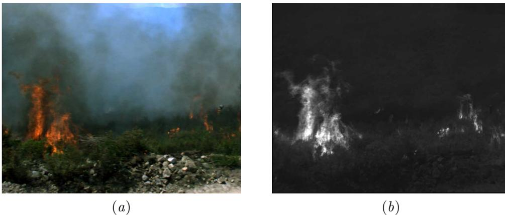
FIGURE 8.9 : Image multimodale obtenue lors du troisième brûlage dirigé. (a) image du spectre visible et (b) Image du spectre proche-infrarouge.
