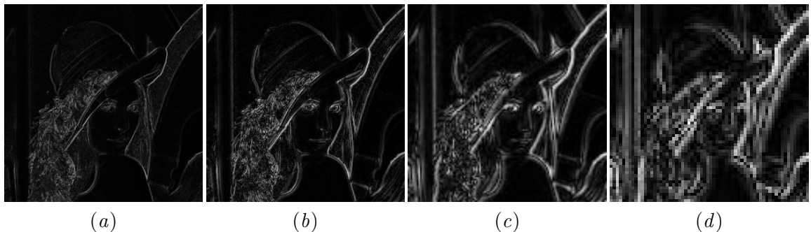
FIGURE 5.5 : Exemple de détails de contraste sur 4 niveaux pour l'image de Lenna ; (a) détails du niveau 0, (b) du niveau 1, (c) du niveau 2 et (d) du niveau 3.
