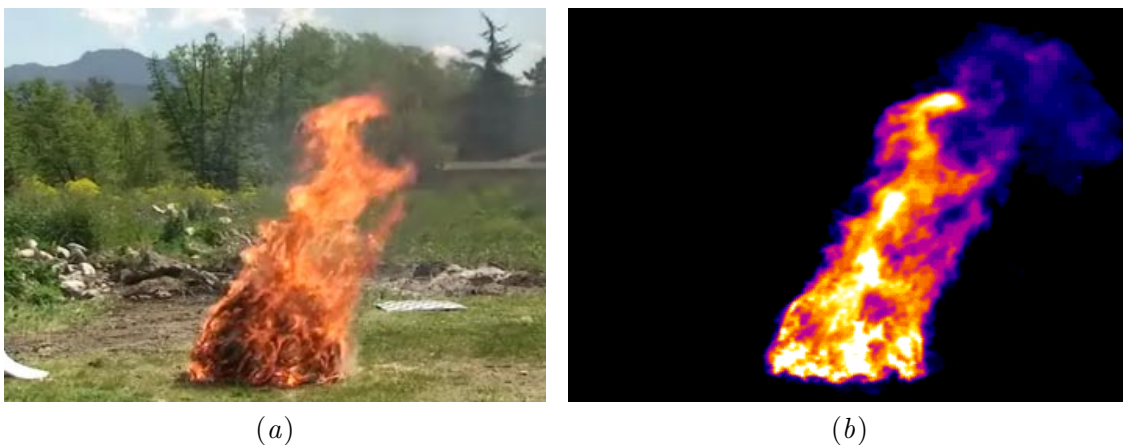
FIGURE 2.8 : Images de feu simultanément acquises dans les domaines du visible et de infrarouge à longueurs d'onde moyennes. (a) Image du spectre visible et (b) image du spectre infrarouge à longueurs d'onde moyennes.
