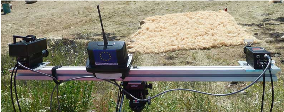
FIGURE 2.13 : Système de stéréovision proposé. L'appareil au centre est l'antenne réceptrice permettant de déclencher les caméras.
