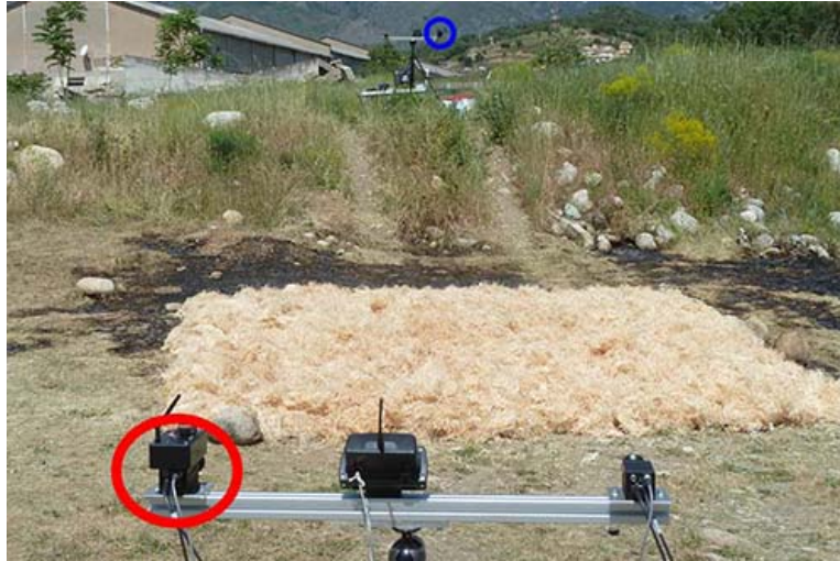
FIGURE 8.1 : Configuration de l'expérience. Les caméras gauches des systèmes de stéréovision avant et arrière sont respectivement entourés en bleu et rouge.
