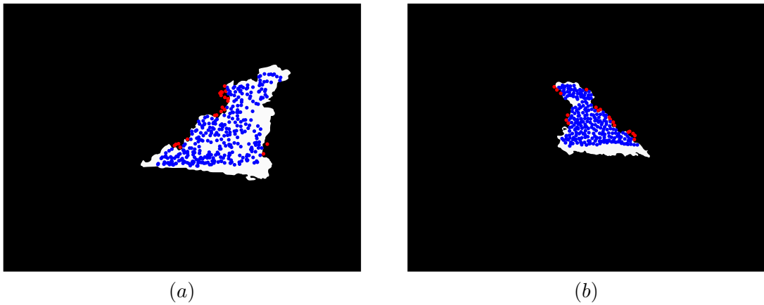
FIGURE 7.6 : Reprojection des points après optimisation. (a) Points issus de la vue arrière reprojétés sur l'image présentant les pixels de feu détectés à partir de la vue avant et (b) Points issus de la vue avant projetés sur l'image présentant les pixels de feu détectés à partir de la vue arrière. Les points rouges sont les points considérés comme des mauvaises reprojections.
