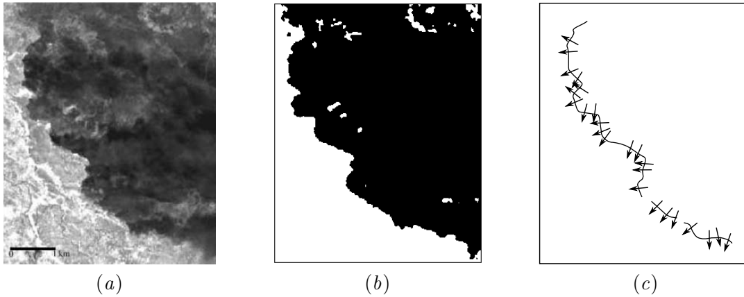
FIGURE 1.12 : Calculs de paramètres sur une image multispectrale. (a) l'image multispectrale, (b) la segmentation de la zone brûlée (en noir) et (c) la direction du front de feu en certains points de la ligne de front [94].
