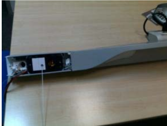
Figure 56 -Emplacement du capteur de présence dans le luminaire placé au-dessus du lit.
