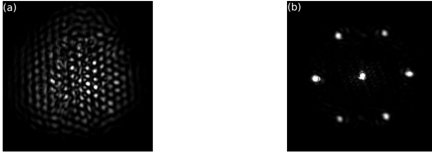
FIGURE 2.35 – Exemples d'images d'instabilités dans le rouge en présence d'un PBS dans la boucle, observés dans le canal \perp du PBS. (a) en champ proche et (b) en champ lointain.
