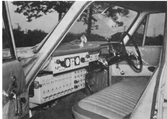
Figure 3: Habitacle du premier véhicule automatisé capable de conduire à basse vitesse sans intervention humaine, Laboratoire d'Ingénierie Mécanique, Tsukuba, Japon.
