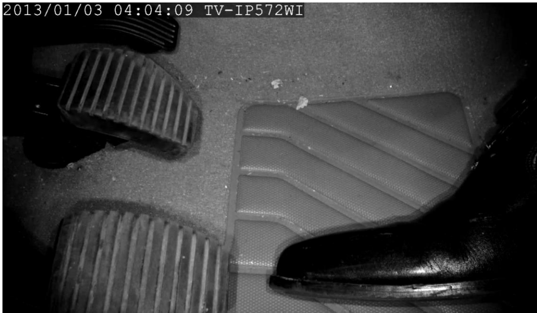
Figure 15 : Prise de vue dans l'habitacle du véhicule pour mesurer la précision de l'utilisation des pédales
