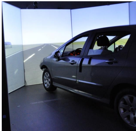
Figure 11 : Le simulateur de conduite de l'IFSTTAR, à Satory
