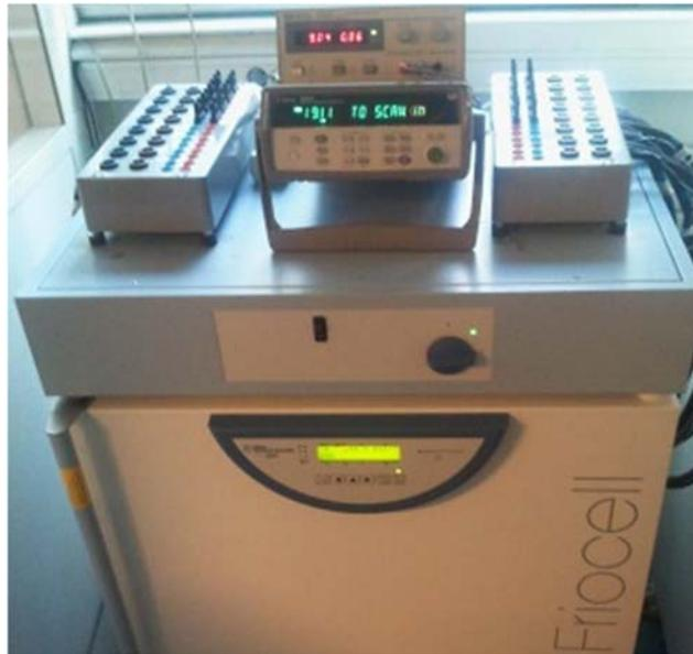
Figure 3.2 Banc de cyclage thermique en fonctionnement
