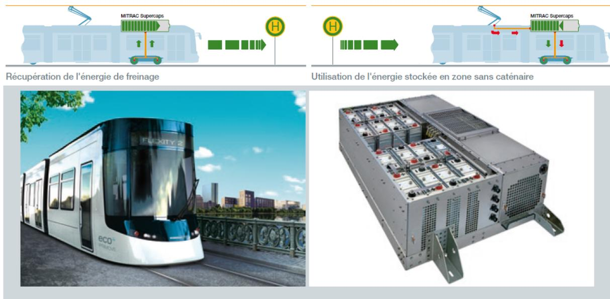
MITRAC Supercaps est intégré dans la nouvelle plateforme de véhicules sur rail légers BOMBARDIER\* FLEXITY\* 2, en tant qu'option standard
