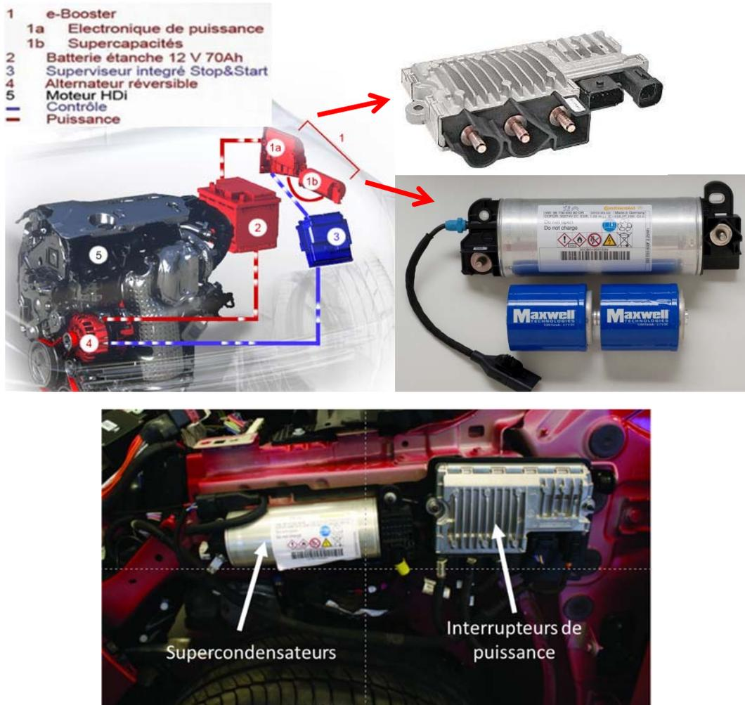
Figure 1.16 Principe, composants et implantation au sein du véhicule du système e-HDi PSA (fonction Stop/Start + dispositif de maintien de tension centralisée)
