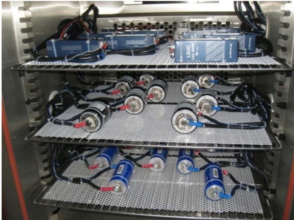
Figure 2.6 Disposition des échantillons pour un test de vieillissement calendaire simple
