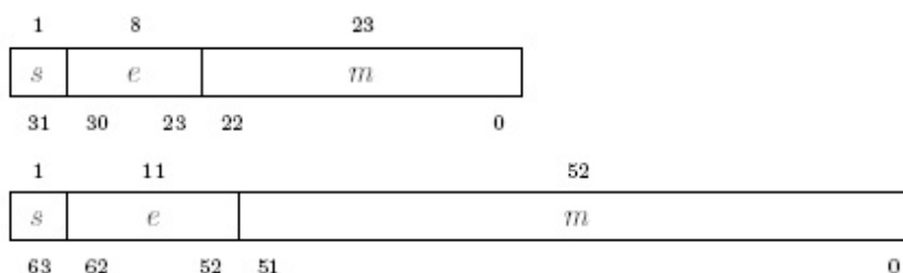
FIGURE 2.2 – Détail du nombre de bits d'un nombre flottant en précision simple et double dans la norme IEEE 754.
