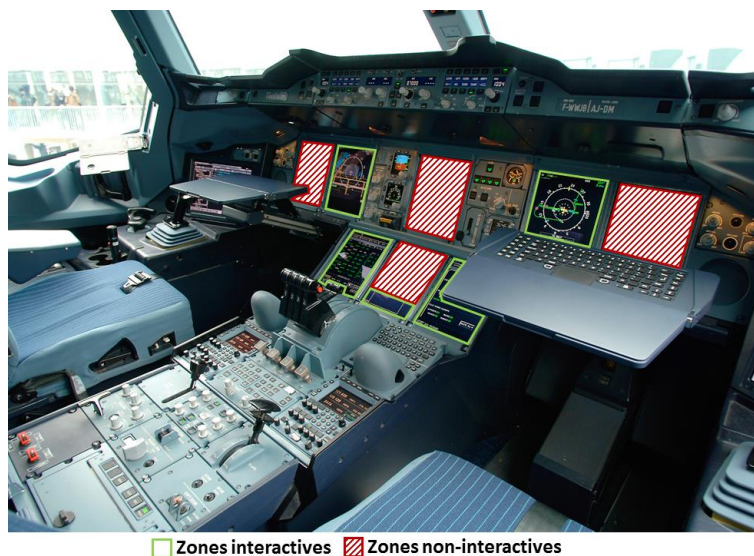
Figure 1.8. Restrictions des zones interactives sur le cockpit de l'Airbus A380
