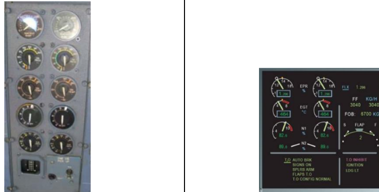
a) Affichage des paramètres moteurs d'un A300 | b) Affichage des paramètres moteurs d'un A320
