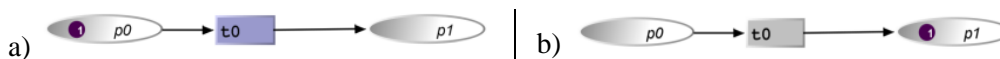
Figure 5.4. État d'un réseau de Petri avant (a) et après (b) un franchissement de transition
