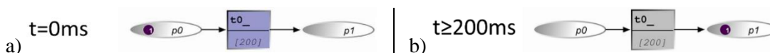
Figure 5.7. État d'un réseau de Petri avant (a) et après (b) le franchissement d'une transition temporisée
