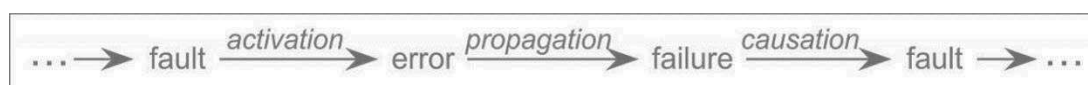
Figure 2.6. Chaîne de causalité des entraves à la sûreté de fonctionnement et à la sécurité (Avizienis, Laprie, et al. 2004).
