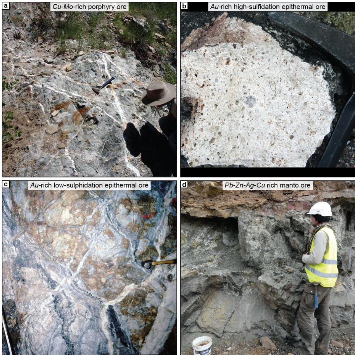
Figure 1.8 : illustrations de la morphologie des différents corps minéralisés qui peuvent se déposer dans un environnement de subduction. (a) Stockwerk à cuivre et molybdène caractérisant un gisement porphyrique, Los Tamales project , Mexique (source : www.sundanceminerals.com ). (b) Vuggy silica à or, caractérisant un gisement de type épithermal acide, Colquijirca District , Pérou (source : J. Tuduri ). (c) Veines rubanées à or et argent caractérisant un gisement de type épithermal neutre, Golden Cross Mine , Nouvelle-Zélande (source : www.sjsresource.com.au ). (d) Minéralisation de remplacement de type manteau dans un banc carbonaté, Morrococha District , Pérou (source : J. Tuduri ).
