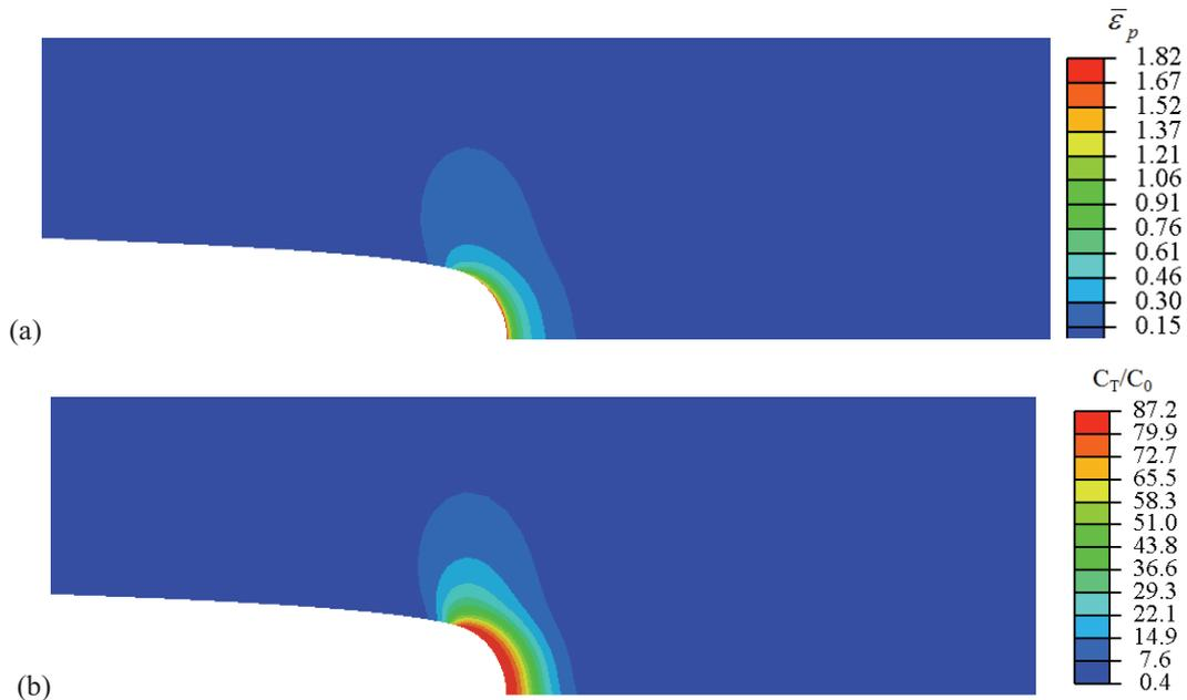
**Figure III.2.12.** (a) Carte de la déformation plastique équivalente (temps du chargement  $t_1=1,3$  s) et (b) carte de la concentration normalisée de l'hydrogène piégé  $C_T$  (temps du chargement  $t_1=1,3$  s).
