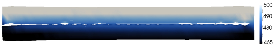
FIGURE 5.20 – Champ de déplacement longitudinal de la corrélation d'images étendue.
