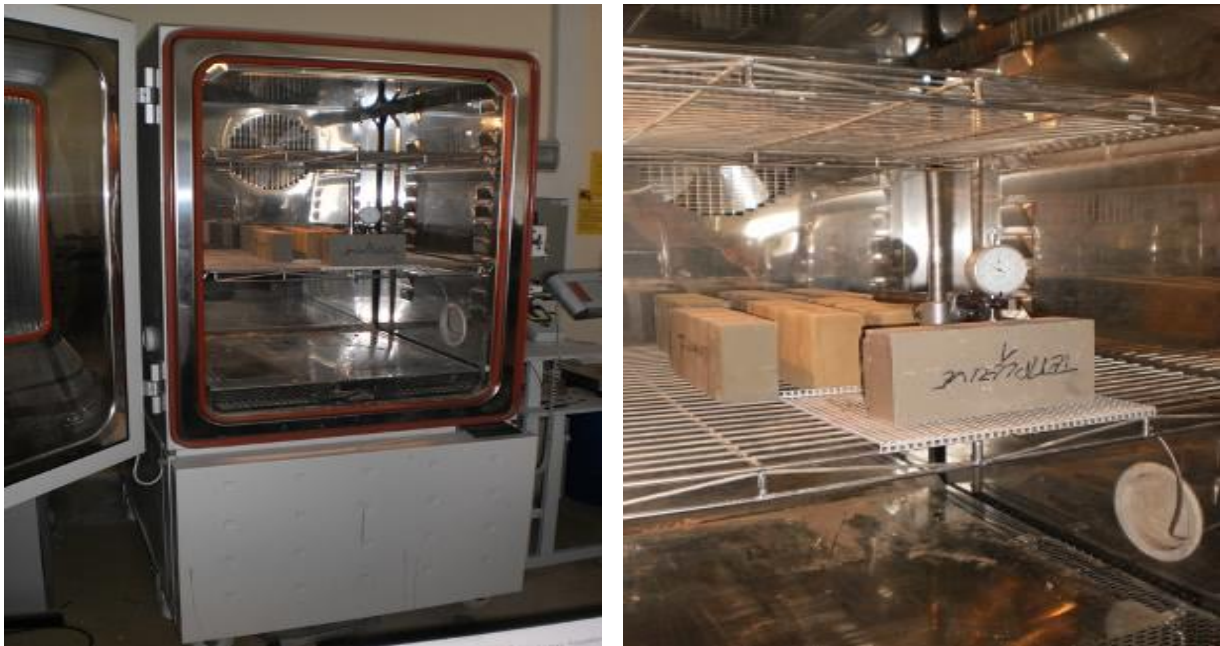
Figure 3.13. Mise en place des briques dans l'enceinte climatique
