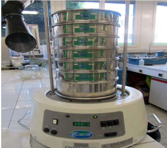
Figure 2.10. Tamisage par voie humide (> 63 µm)
