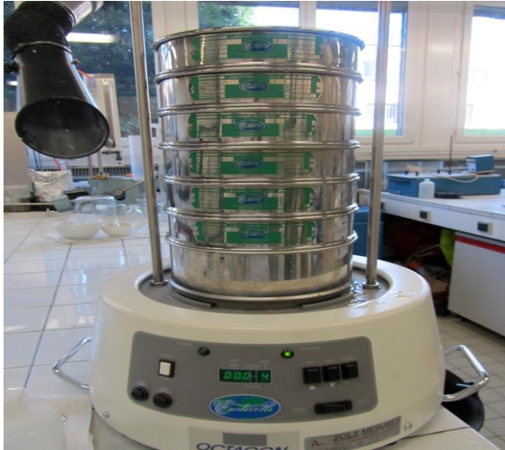
Figure 2.10. Tamisage par voie humide (> 63 µm)
