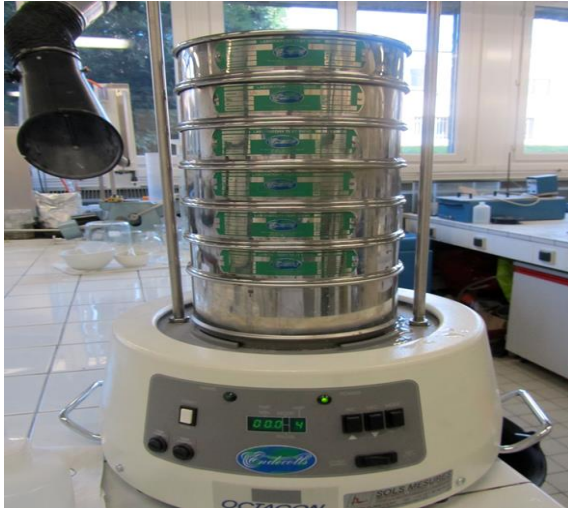
Figure 2.10. Tamisage par voie humide (> 63 µm)
