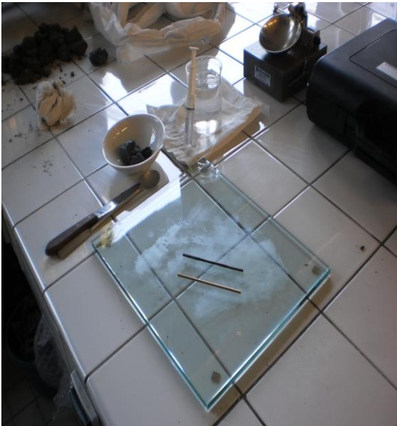
Figure 2.8. Limite de plasticité au rouleau
