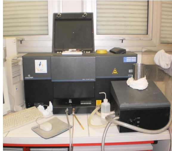
Figure 2.11. Granulomètre Laser COULTER LS 230 (< 63 µm)
