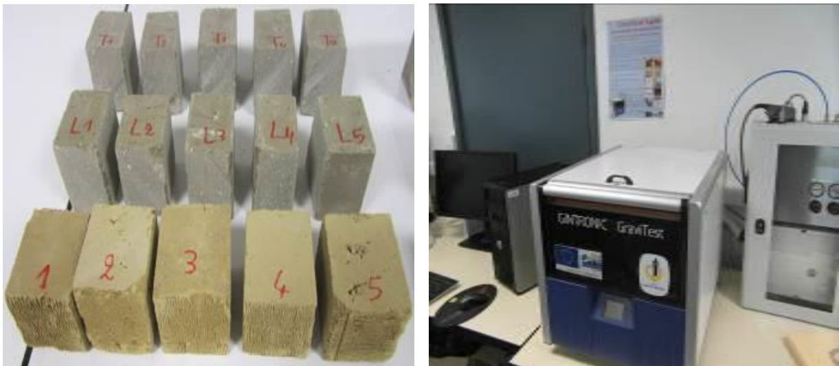
Figure 3.15. Eprouvettes des briques en terre crue et Essai au Gravitest
