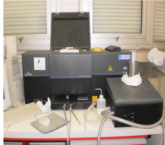
Figure 2.11. Granulomètre Laser COULTER LS 230 (< 63 µm)
