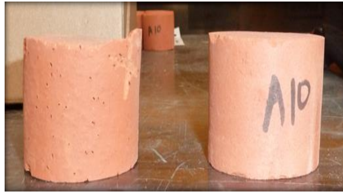
Figure 4.9. Eprouvettes avec 10% d'amidon
