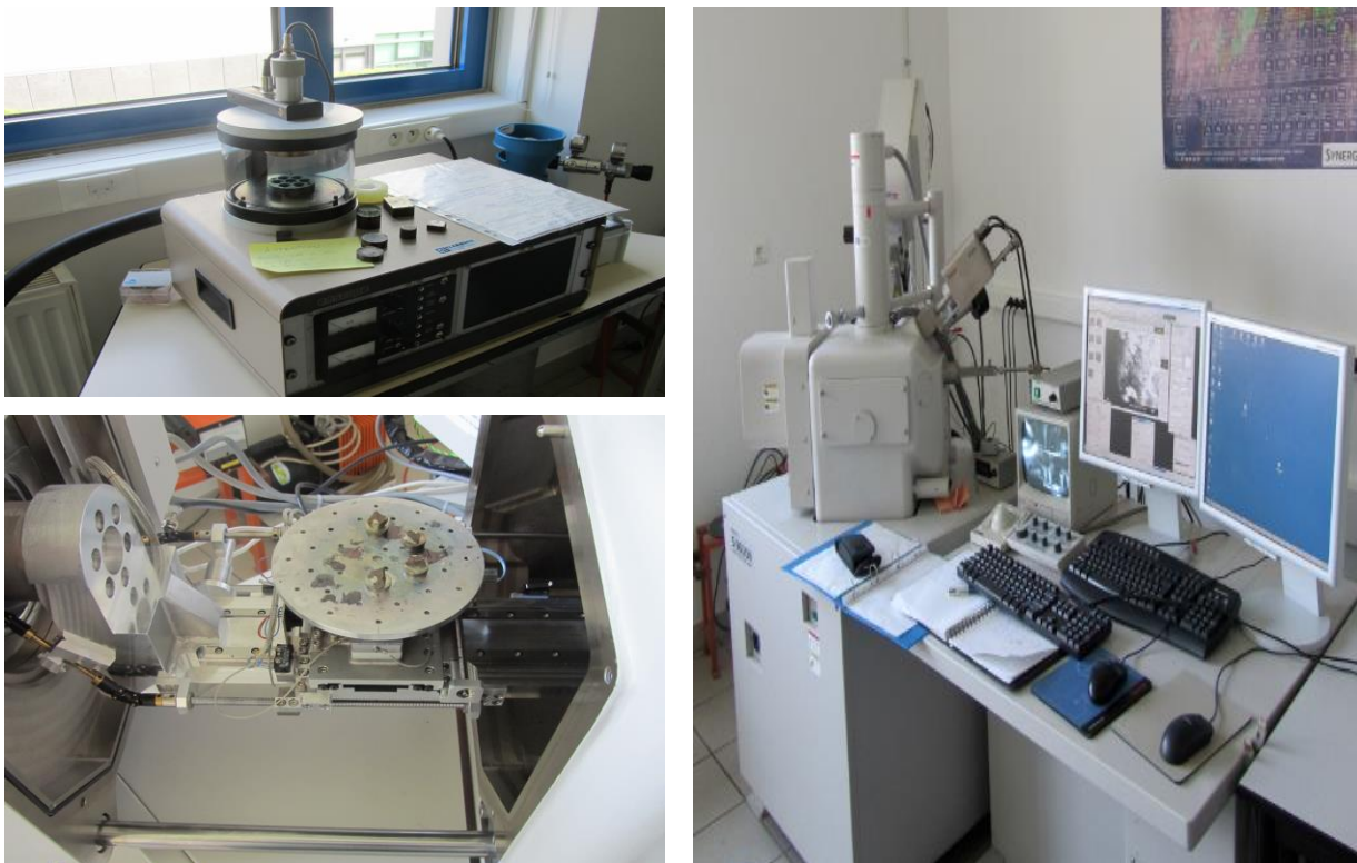
Figure 2.24. Métalliseur et MEB HITACHI S-3600N
