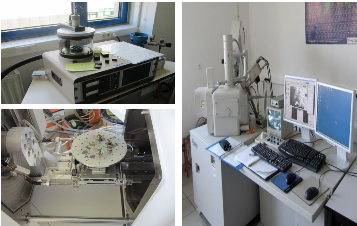
Figure 2.24. Métalliseur et MEB HITACHI S-3600N
