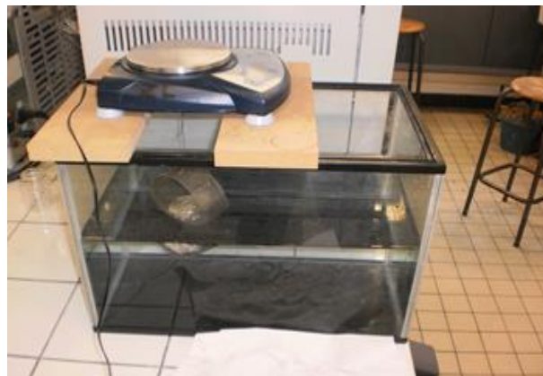
Figure 2.6. Méthode de la pesée hydrostatique
