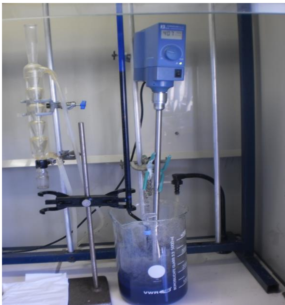
Figure 2.14. Essai au bleu de méthylène
