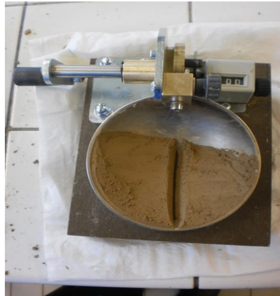
Figure 2.9. Limite de liquidité à la coupelle de Casagrande
