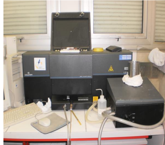
Figure 2.11. Granulomètre Laser COULTER LS 230 (< 63 µm)
