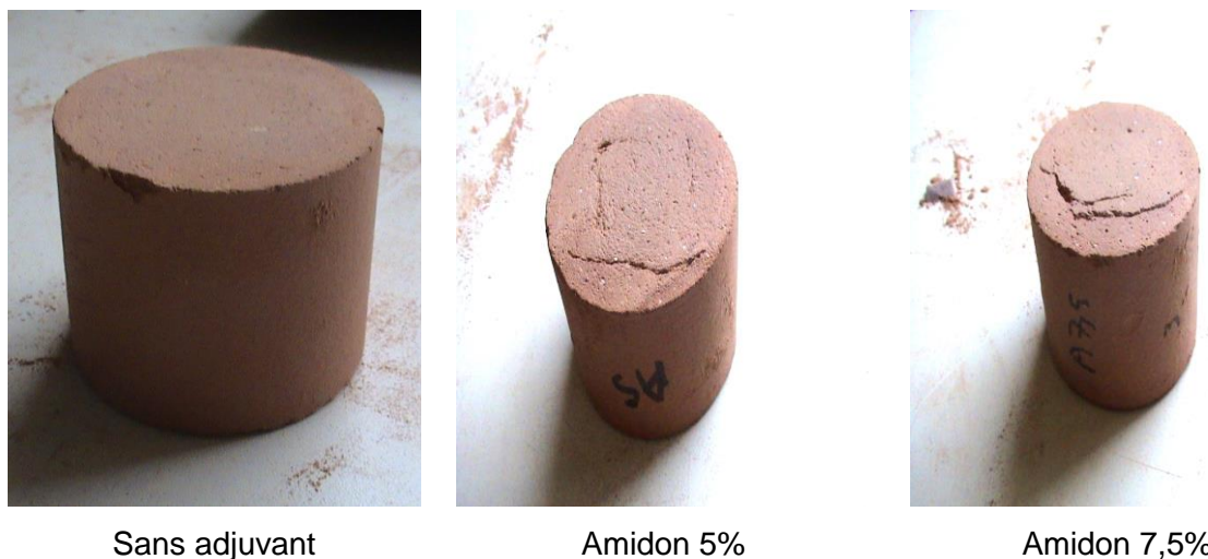
Figure 4.8. Comparaison des éprouvettes avec l'amidon avec celle sans adjuvant
