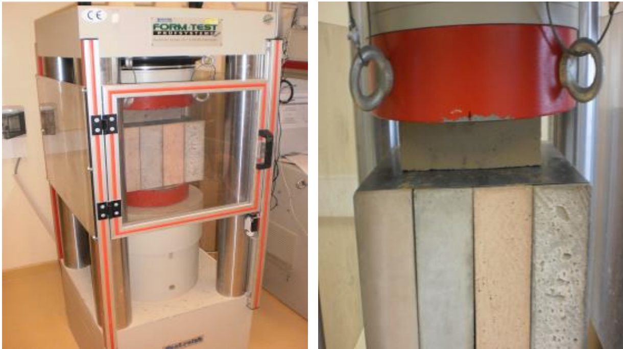
Figure 3.17. Essais mécaniques sur les briques en terre crue
