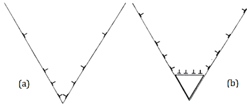
Figure 1.6. Représentation schématique d'un exemple de nucléation d'une fissure suite à l'intersection de deux empilements de dislocations : (a) Deux empilements de dislocations coïncident se bloquant entre elles selon leurs plans de glissements, (b) les dislocations principales réagissent alors pour former une nouvelle sorte et créent ainsi un vide ou une microfissure selon la ligne d'intersection des deux plans de glissements [45]
