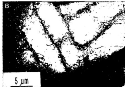
Figure 3.11. Arrangement de dislocations dans la direction normale à l'axe de chargement : 2 ème stade de fatigue (N=400 sur la Figure 3.5, échantillon en aluminium pur) [12]
