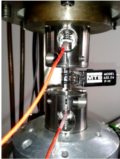
Figure 4.2. Photo du montage des capteurs d'EA sur une éprouvette MFC
