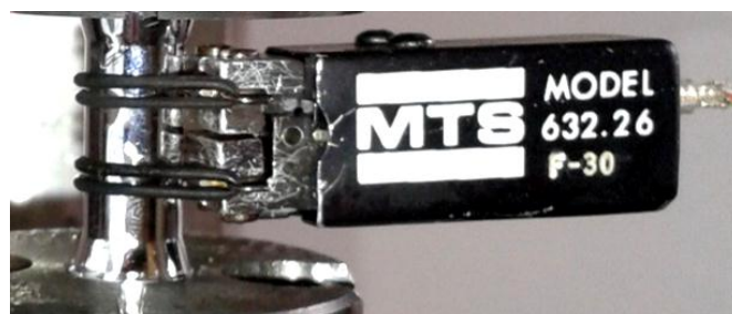
Figure 2.8. Extensomètre fixé sur une éprouvette MFC
