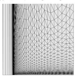
(d)  $\mathcal{M}_{L^p}$  metric, metric-aligned mesh generation.
