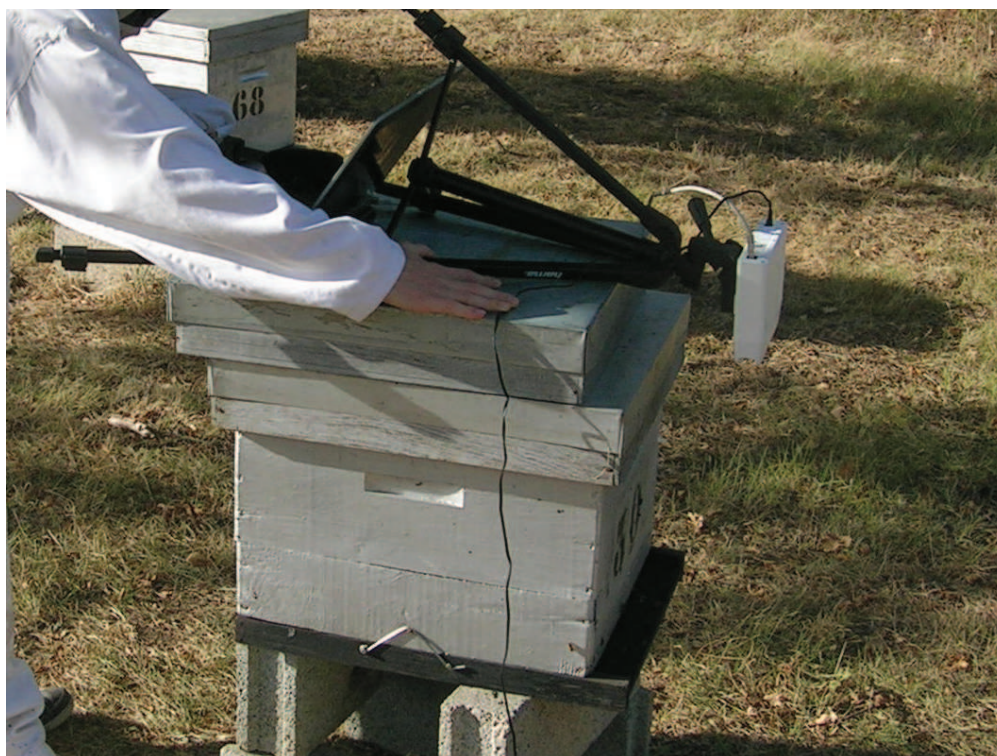
Figure 1.16 – Dispositif d'acquisition stéréovision fixé à l'entrée d'une ruche. Cette manipulation fut effectuée à l'INRA Magneraud dans le cadre de la première campagne de tests en 2012.
