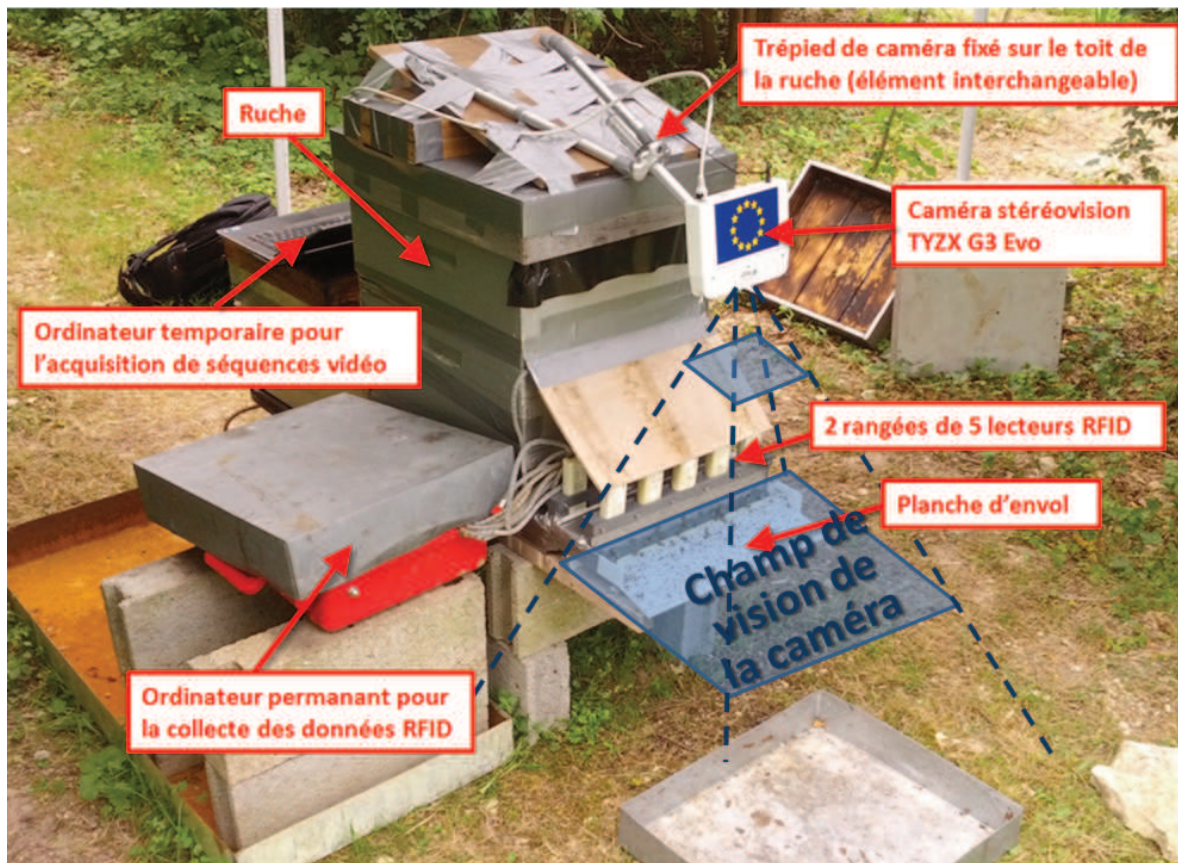
Figure 4.3 – Dispositif d'acquisition stéréovision à l'entrée de la ruche. Le trépied servant à tenir la caméra est fixé sur un toit de ruche mobile. Cela permet de conserver la même configuration (inclinaison, hauteur de la caméra) lors des déplacements. Sur des ruches standards, les séquences vidéo sont ainsi acquises dans un même référentiel. À savoir que le dispositif d'acquisition doit être mis à l'abri après chaque journée d'acquisition, permettant par la même occasion aux apiculteurs d'intervenir sur la ruche entre 2 journées de manipulation.
