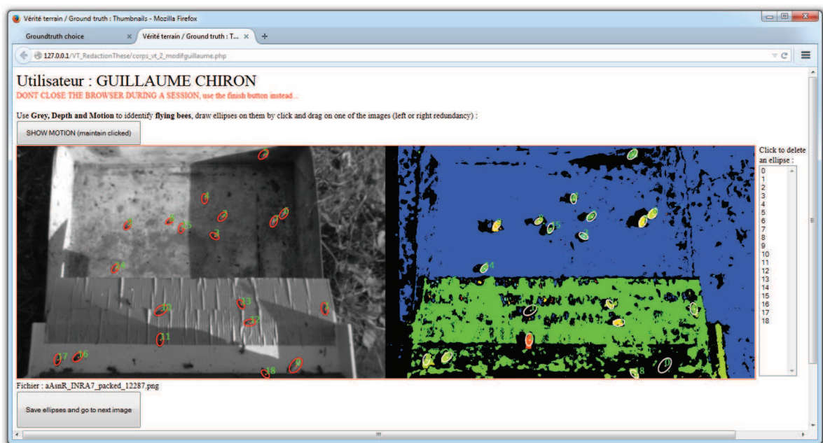
Figure A.1 – Capture d'écran de l'outil d'annotation de cibles. Image de gauche : information d'intensité ; image de droite : information de profondeur correspondante ; bouton "SHOW MOTION" : affiche le couple intensité/profondeur suivant au sein de la séquence ; ellipses : abeilles en vol annotées.
