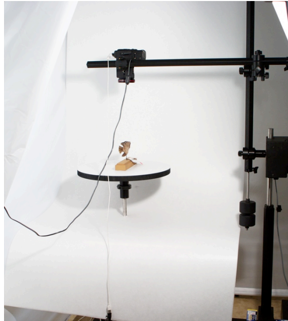
Figure 66. Arrangement pour photographier les objets sous toutes leurs perspectives
