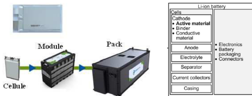
Figure 4.9. Décomposition et Composition d'une batterie. (Swart et al., 2014; Väyrynen and Salminen, 2012).
