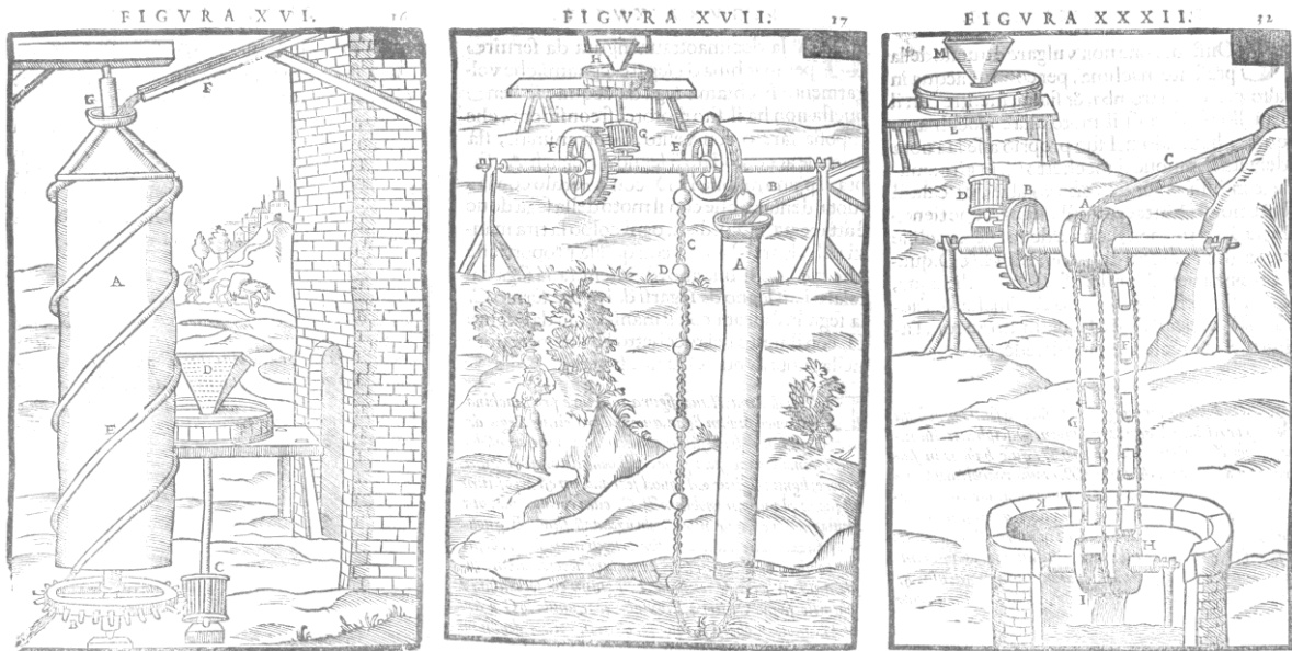
Figure 25 : Moyens d'élever l'eau détournés et utilisés comme moteur pour des meules. Figure 16, 17 et 32 de Giovanni Branca, Le Machine (Rome, 1629)
