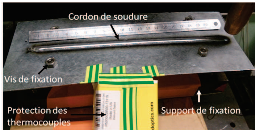
FIGURE V.2: Système de bridage de l'éprouvette.
