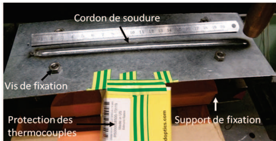
FIGURE V.2: Système de bridage de l'éprouvette.
