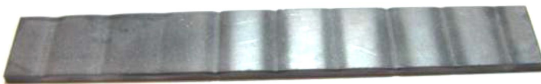
Figure 2.9 Eprouvette en titane utilisée pour la répétabilité procédé
