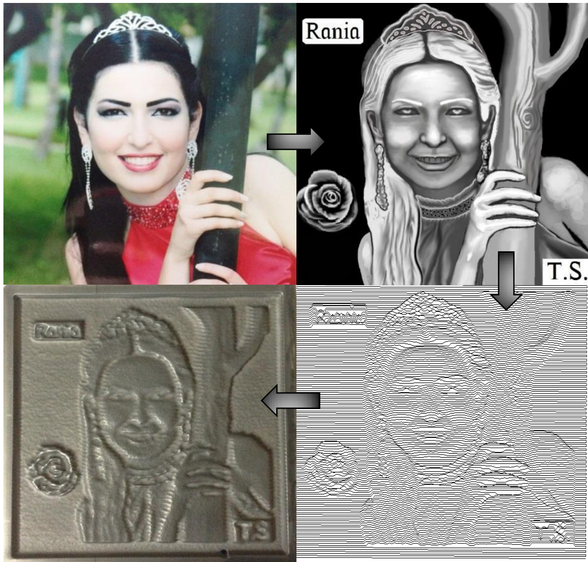
Figure 4.23 Exemple d'application de la stratégie par balayage continu
