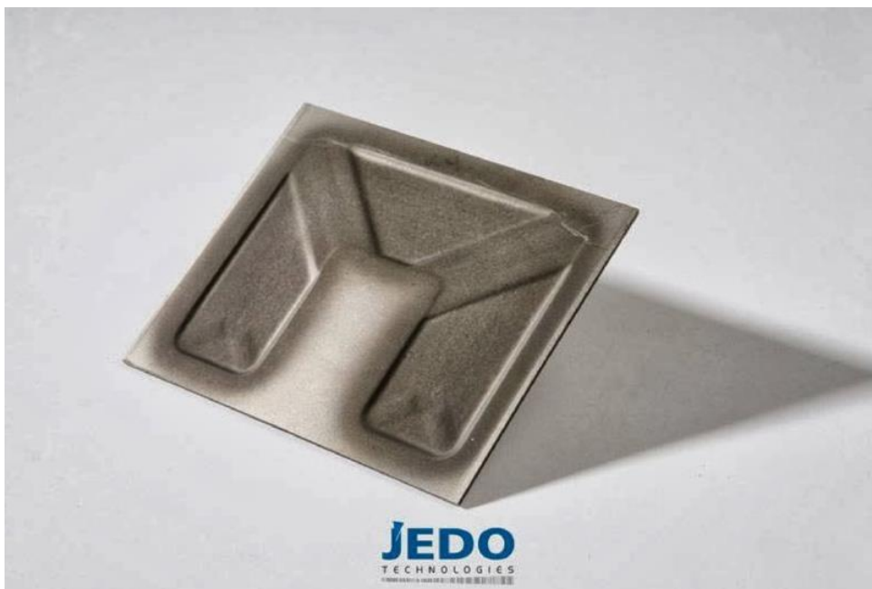
Figure 4.10 Apparition des bosses sur les coins arrondis (JEDO Technologies)
