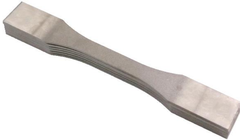
Figure 1.15 Découpe en pile de plaque de titane Ti6Al4V Grade 5 (norme ISI).
