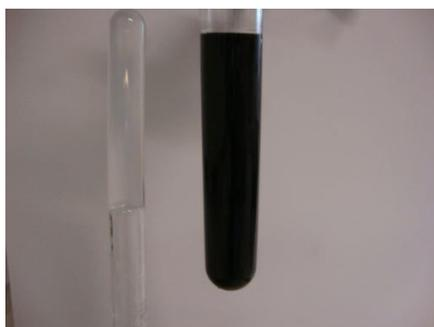
Figure III. 4 - Gel de SnO<sub>2</sub> (tube de gauche), Solution hybride SnO<sub>2</sub>/SWNTs (tube de droite).
