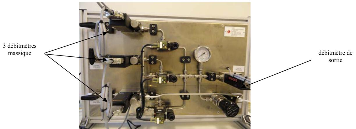
Figure II. 14 - Photo du banc de dilution.
