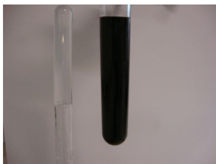
Figure III. 4 - Gel de SnO 2 (tube de gauche), Solution hybride SnO 2 /SWNTs (tube de droite).
