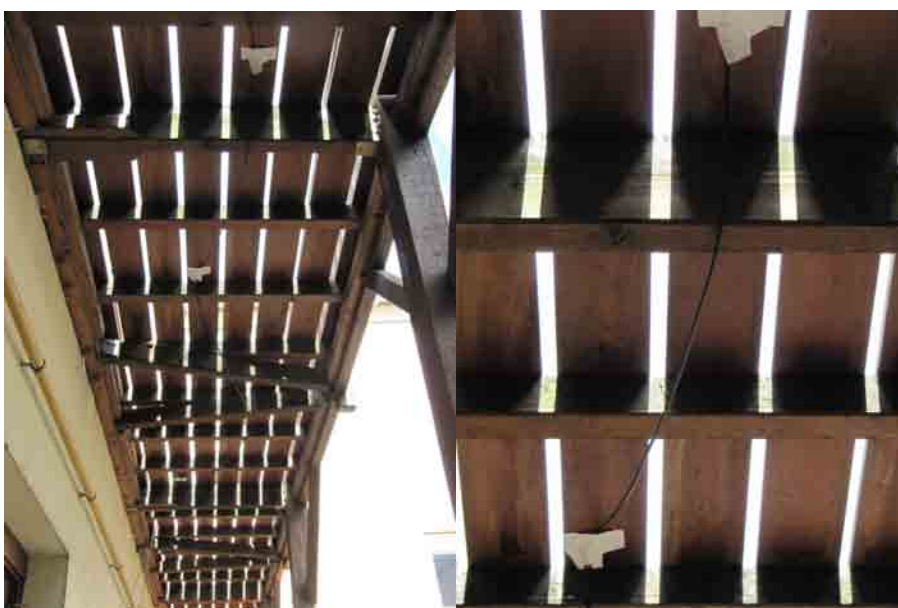
Photographies : Positionnement des microphones piezo sous le platelage de
