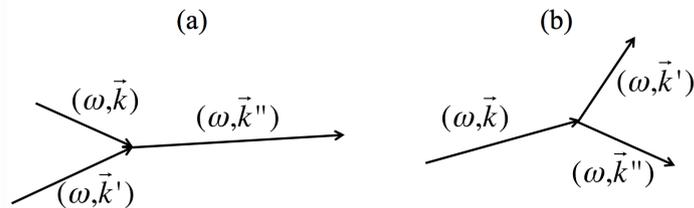
**Figure 1.12** – (a) Processus inélastique correspondant à la destruction de deux phonons  $(\omega, \vec{k})$  et  $(\omega', \vec{k}')$  et à la création d'un phonon  $(\omega'', \vec{k}'')$ . (b) Processus inélastique correspondant à la destruction d'un phonon  $(\omega, \vec{k})$  et à la création de deux phonons  $(\omega', \vec{k}')$  et  $(\omega'', \vec{k}'')$ .
