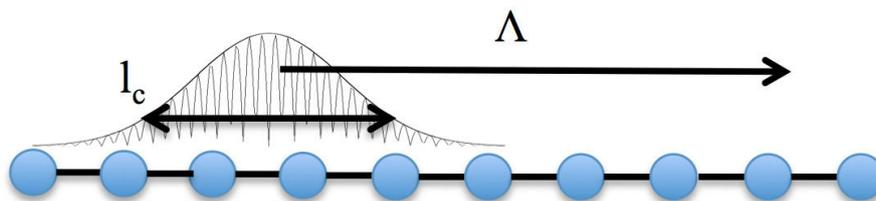
**Figure 2.5** – Représentation schématique de la valeur absolue d'un paquet d'onde de phonon et de son enveloppe, possédant un libre parcours moyen  $\Lambda$  et de longueur de cohérence spatiale  $l_c$  le long d'une chaîne unidimensionnelle.
