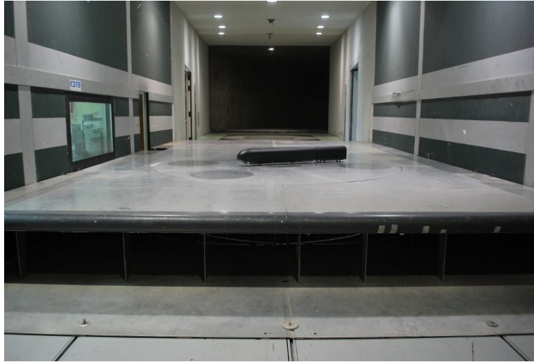
FIGURE 2.8 – Modèle de train régional installé dans la veine d’essais de la soufflerie climatique Jules Verne à 60^\circ de dérapage.
