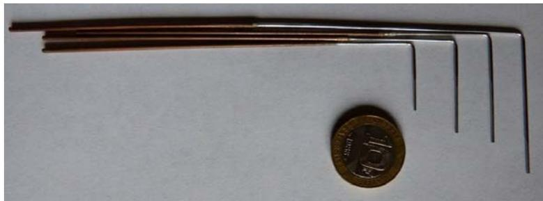
FIGURE 2.31 – Sondes utilisées pour les mesures de couche limite, la longueur dépend du dérapage et de l'orientation associée.
