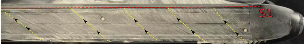
FIGURE 3.2 – Spectre pariétal sur le toit du modèle de train idéalisé, \beta = 30^\circ .
