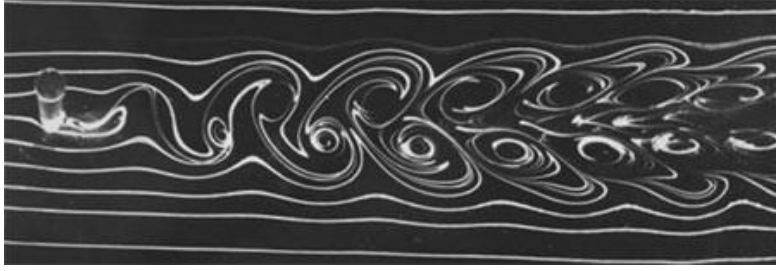
FIGURE 2.11 – Écoulement derrière un obstacle cylindrique mis en évidence par de la tomoscopie laser, photographie de P. Bradshaw, reproduite dans An Album of Fluid Motion , Milton Van Dyke [98].
