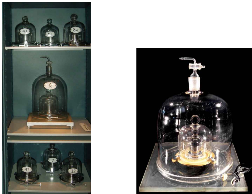
FIGURE 1.1 – Figure gauche : Coffre contenant le prototype international du kilogramme, conservé dans l’air au BIPM sous 3 cloches de verre ainsi que ses 6 copies officielles. Figure issue de [14]. Figure droite : Copie du prototype international du kilogramme \text{kg} . Figure issue de [21].
