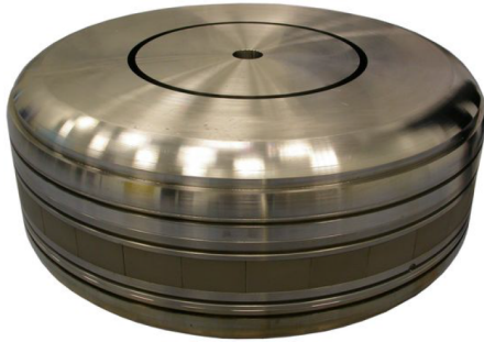
FIGURE 2.11 – Photographie du circuit magnétique. Diamètre extérieur 550 mm. Figure issue de [171].
